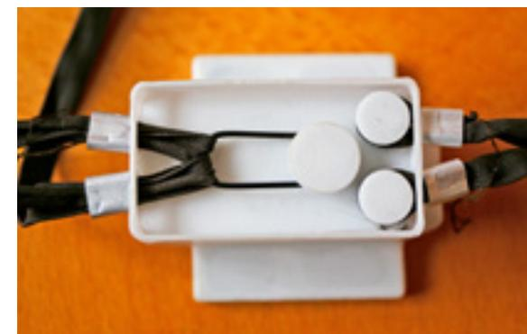
Abb. 22: Diese Sollbruchstelle wurde speziell für die Backpacks entwickelt. (Foto: Christoph Leditznig)
