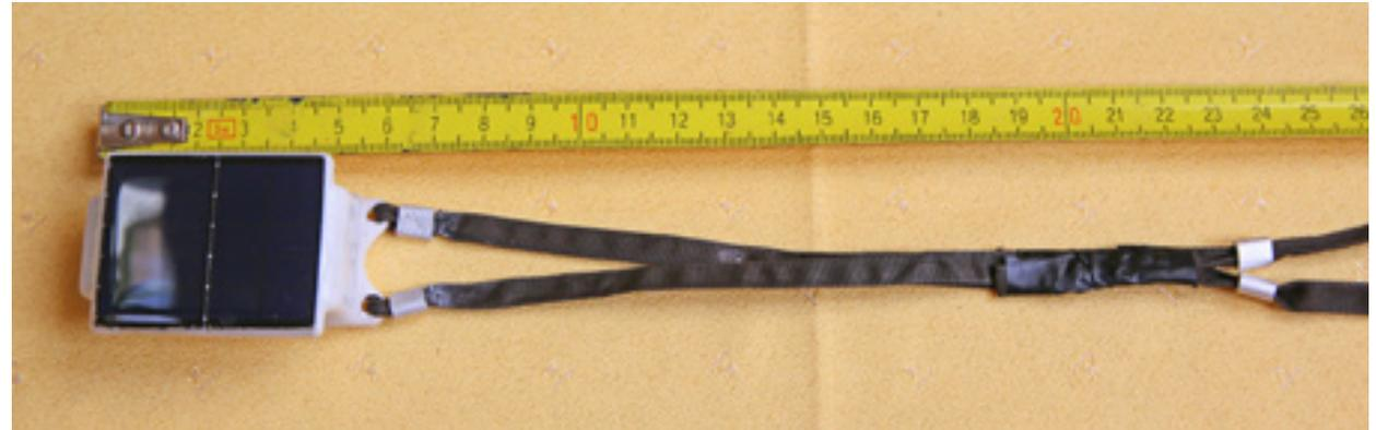
Abb. 11 & 12: Solarsender der Fa. Ecotone, die im Habichtskauzprojekt getestet wurden. Auch der Solarsender mit 2 Solarmodulen (rechtes Foto) führte nicht zum gewünschten Erfolg, da beide Module von den Federn der Käuze überdeckt wurden. (Fotos: Christoph Leditznig)
