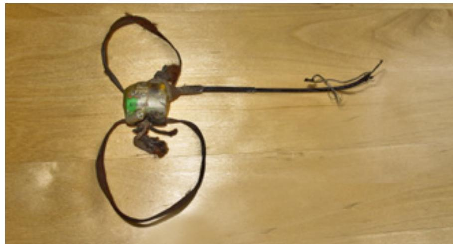
Abb. 7: Beckenmontage bei einem terrestrischen Sender. Man beachte die relativ starke Deformation der Antenne nach dem Senderabwurf. (Foto: Christoph Leditznig)
