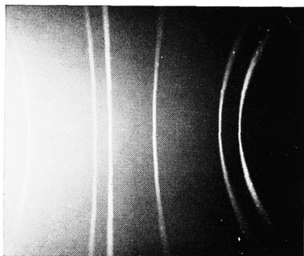
Abb. 9. Erholte Probe ohne Entfestigung
