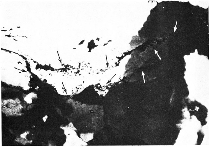
Abb. 18: Annähernd s-parallele Zinnobereicherung (Pfeile) im Erzquarzit als Interngefüge si. Quarzkörner (weiß bis grauschwarz, z. T. erkennbar undulös) umwachsen älteren, flächig verteilten Zinnobereicherung (schwarz). Dünnschliff, Nicols +. Natürliche Größe des Bildausschnittes 0,87 \times 0,58 mm.
