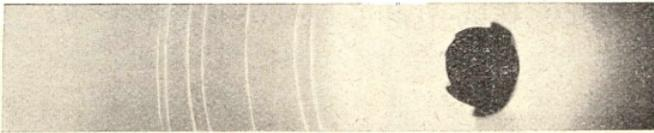
Fig. 3. Debye-Scherrer Aufnahme von Probe 26 (auf Glas aufgedampfte und oxydierte Kupferschicht).
