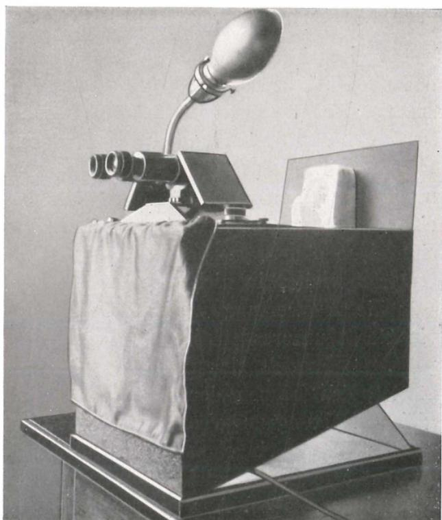
Abb. 4. Das kleine Vierspiegelstereoskop.
