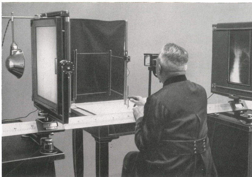
Abb. 2. Die frei bewegliche Lichtmarke mit dem darunter angebrachten Zeichenstift zur Gewinnung von Schnittzeichnungen und Vertikalprojektionen.
