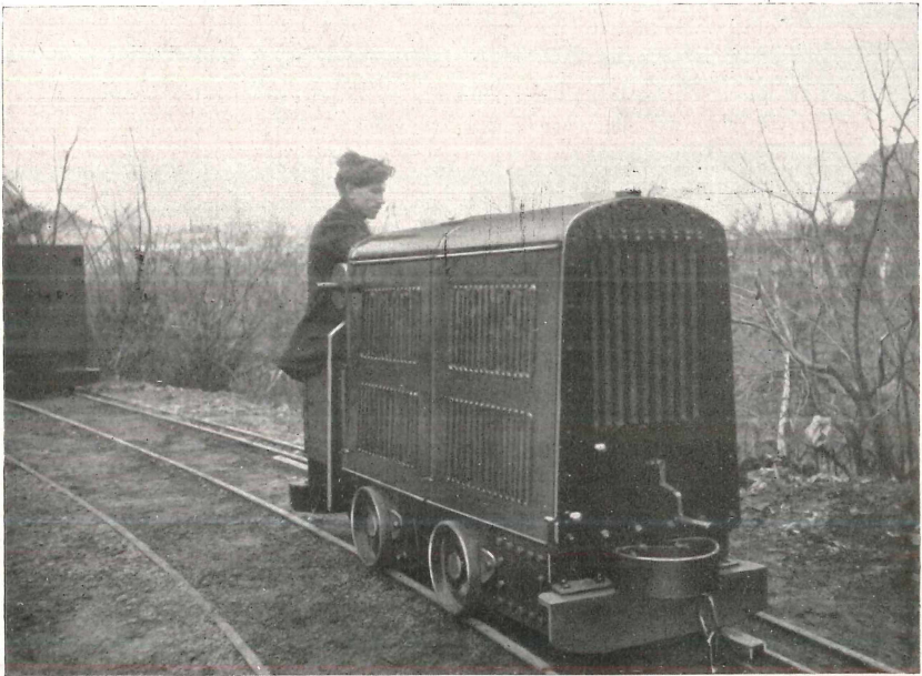
Fig. 2. 10 PS „Kavernen-Lokomotive“ mit benzinelektrischer Kraftübertragung nach dem System „Gebus“ für 450 und 500 mm Spurweite, ermöglicht außer der Zugförderung die Beleuchtung von Höhlenabschnitten und den Betrieb von elektrischen Bohr- und Pumpenanlagen. Größte Höhe: 1250 mm, größte Länge: 2450 mm, größte Breite: 660 mm.
