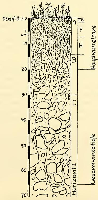
Abb. 3. Schematisches Profil der Pararendsina-Braunerde in Reischach.
