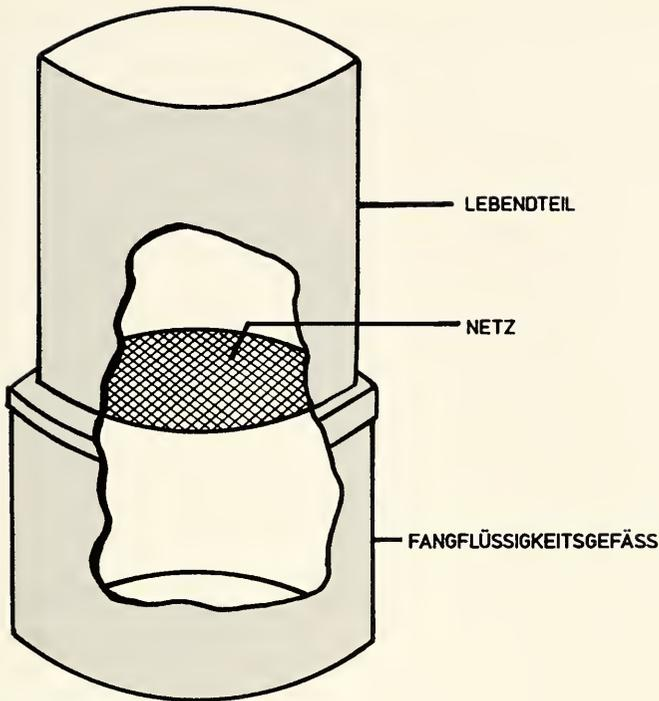
Abb. 8. Aufbau der Fraktionsfalle, schematisch.
