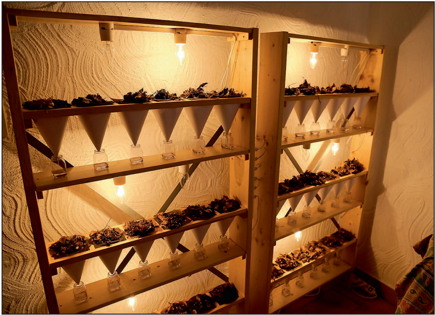
Abb. 1: Berlesegestell - Auflage der Boden/Moosproben auf Gaze (2mm Maschenweite), Austreibung der Collembolen aus den Proben mittels Licht und Wärme. Alle Fotos: H.-J. Schulz.
