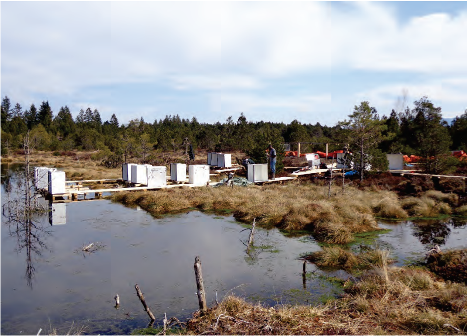
Abb. 4. Haubenmessungen zur Erfassung der Treibhausgasflüsse in einem vor rund 12 Jahren wiedervernässten Bereich des Schechenfilzes. (Foto: M. Drösler, Januar 2011).
