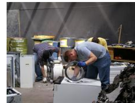
manuelle Zerlegung der Geräte
