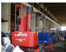
Aufgabe auf Förderband zu Zerlegearbeitsplätzen
