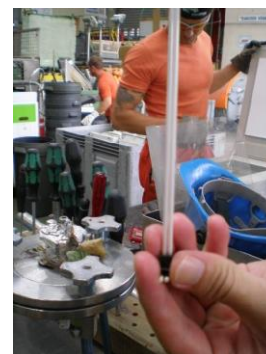
Leuchtstoffröhre aus Scanner
