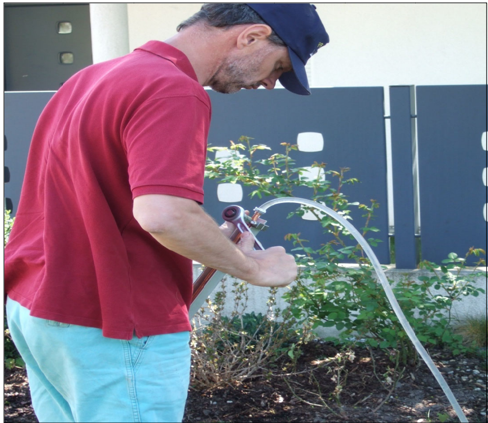
Abbildung 6: Schließen der Rohrenden eines Weichkupferrohres durch Abquetschen mittels Spezialschneiden für die Probenahme von Edelgasen (Helium, Neon). Foto: M. Kralik
