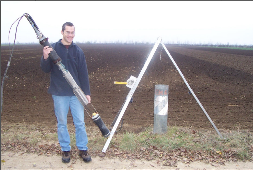
Abbildung 5: Packer mit dem die tiefengestufte Grundwasserprobenahme an der Messstelle EM4 der Betriebsgesellschaft Marchfeldkanal getestet wurde. Foto: F. Humer.
