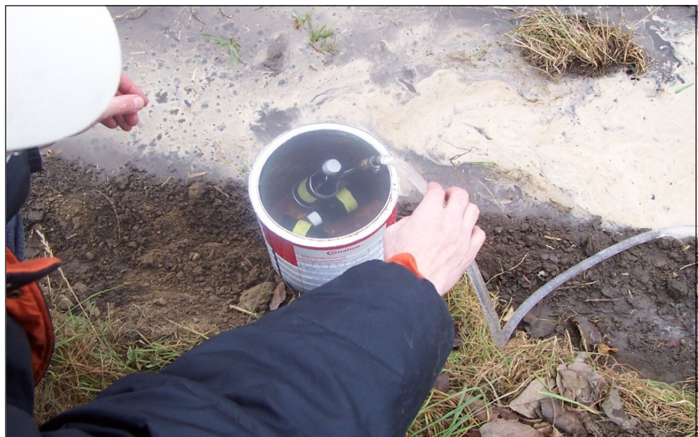
Abbildung 7: Probenahme für die FCKW-Messungen mittels dunkler 100 ml Glasfläschchen mit speziell dichtenden Schraubverschlüssen in einem Metallbehälter. Foto: M. Kralik.
