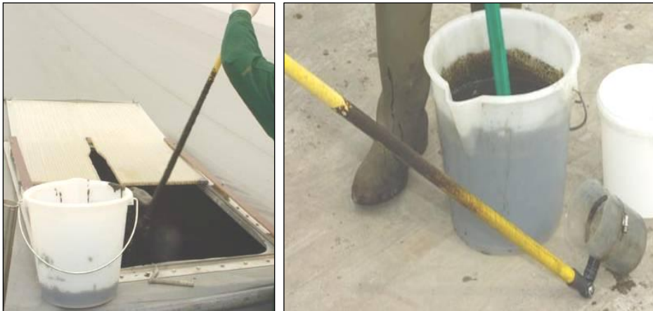
Abbildung 8: Gärrestprobenahme aus einem Pumpschacht der Biogasanlage B. © Bundesgütegemeinschaft Kompost e.V. 2009.
