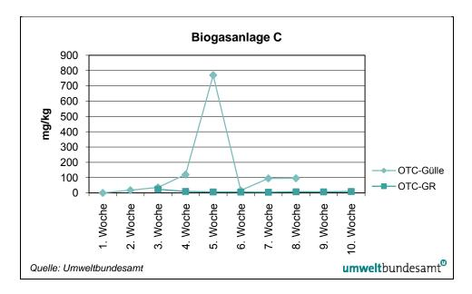
Abbildung 12: Konzentrationsverlauf der Wirtschaftsdünger bzw. der Gärreste von Anlage C (in mg kg<sup>-1</sup> TS).
