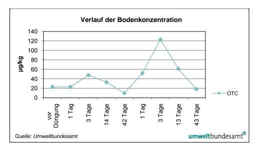
Abbildung 13: Verlauf der Bodenkonzentrationen von Anlage C (in μg kg<sup>-1</sup> TS).
