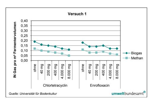
Abbildung 1: Biogas- und Methanproduktion in Abhängigkeit von der Wirkstoffkonzentration (Versuch 1).
