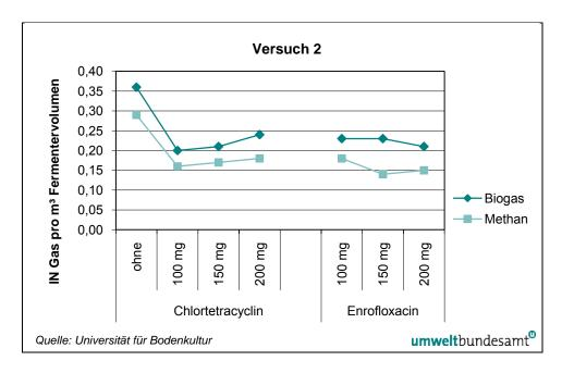
Abbildung 2: Biogas- und Methanproduktion in Abhängigkeit von der Wirkstoffkonzentration (Versuch 2).
