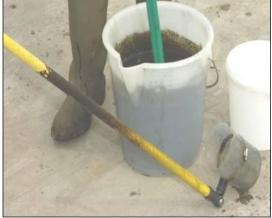
Abbildung 8: Gärrestprobenahme aus einem Pumpschacht der Biogasanlage B. © Bundesgütegemeinschaft Kompost e.V. 2009.
