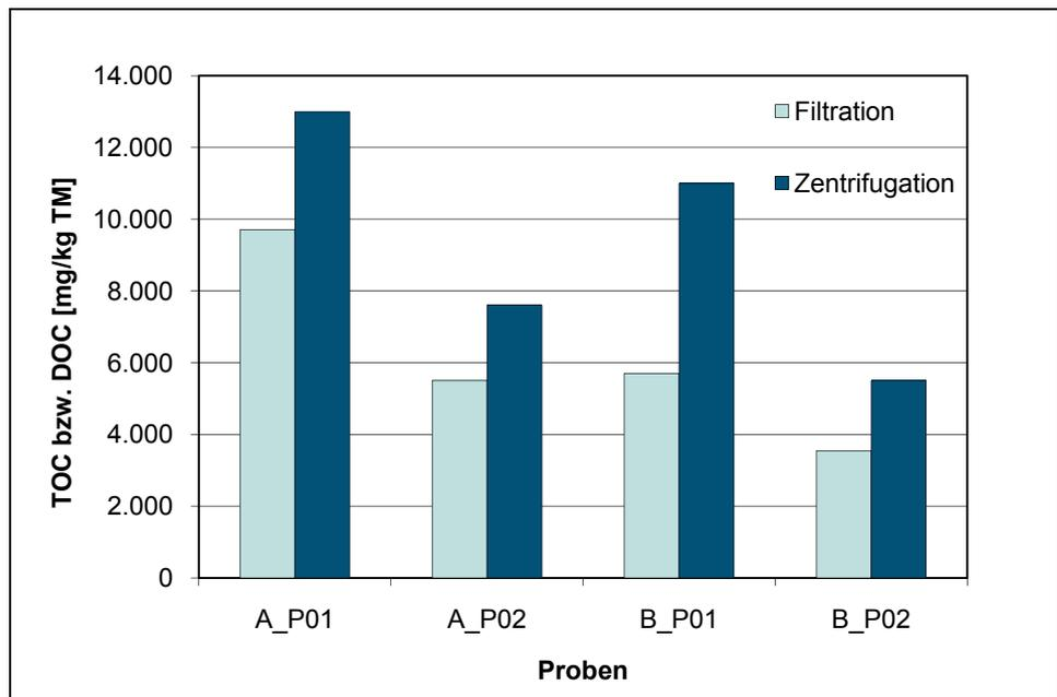
Abbildung 8: Vergleich Filtration und Zentrifugation, Fa. Agrolab.
