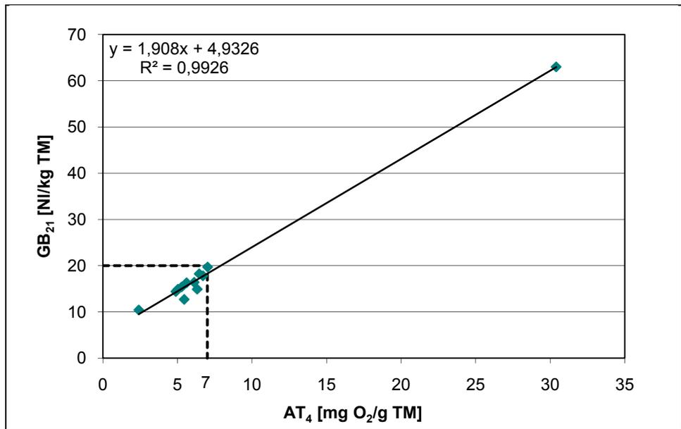
Abbildung 21: Gegenüberstellung  $AT_4$  und  $GB_{21}$  modifiziert, beide Anlagen.
