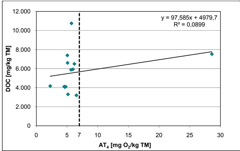
Abbildung 22: Gegenüberstellung AT<sub>4</sub> (Grundlegende Charakterisierung) und DOC, beide Anlagen.
