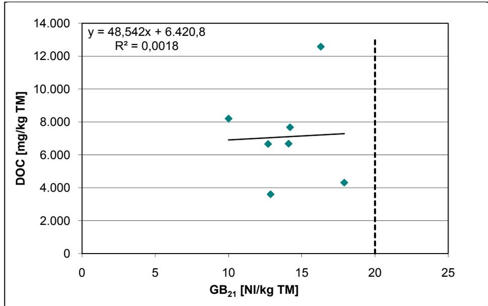
Abbildung 25: Gegenüberstellung GB<sub>21</sub> (Grundlegende Charakterisierung) und DOC, Anlage A.
