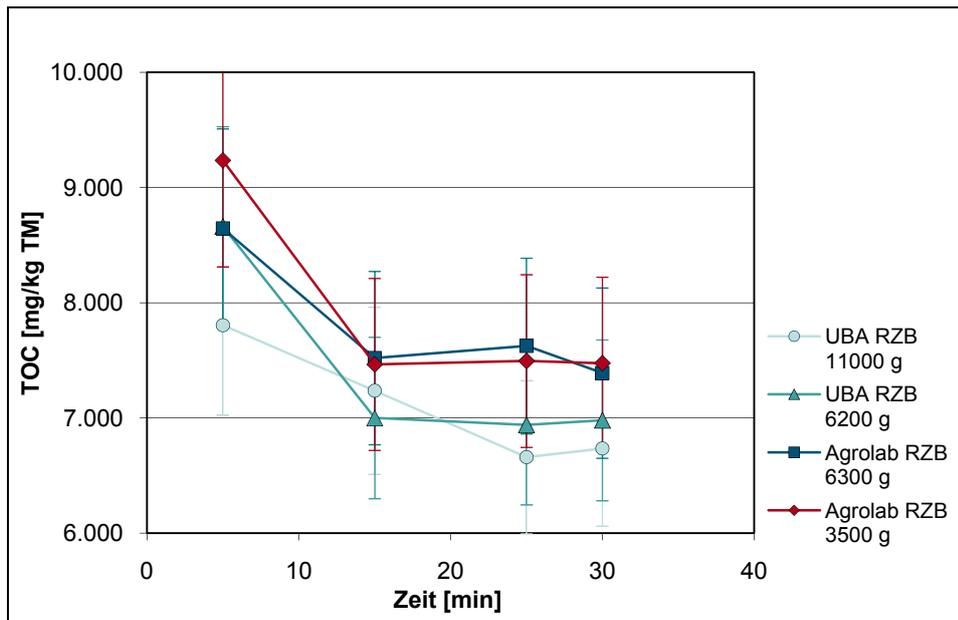
Abbildung 13: Einfluss der RZB auf den  $TOC_{Eluat}$ , A\_P01, Mittelwerte  $\pm$  2 SD.
