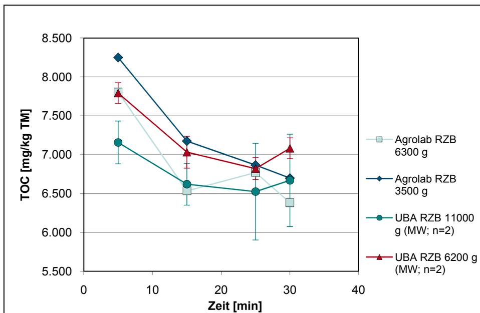
Abbildung 14: Einfluss der RZB auf den  $TOC_{Eluat}$ , A\_P02, Mittelwerte  $\pm$  2 SD.
