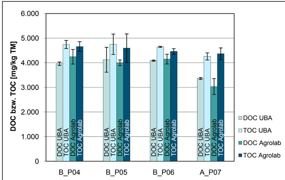
Abbildung 16: Phase 3, Teil 2, DOC und TOC<sub>Eluat</sub> Mittelwerte ± 2 SD.
