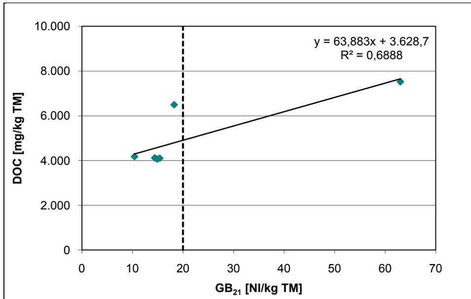
Abbildung 27: Gegenüberstellung GB<sub>21</sub> modifiziert und DOC, Anlage B.
