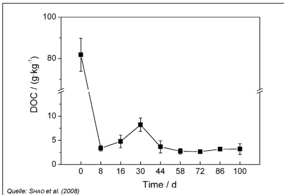
Abbildung 1: Entwicklung des DOC während 100 Tagen Biostabilisation von kommunalem Abfall.
