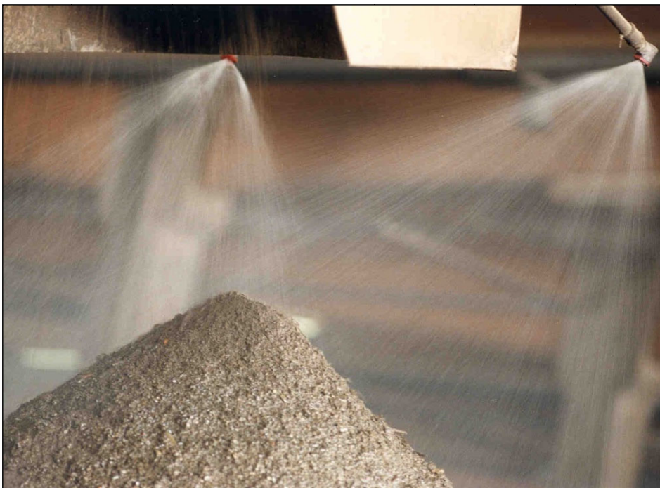
Abbildung 6: Ökotechna – Bedüsung des Materials (© ALTEC).
