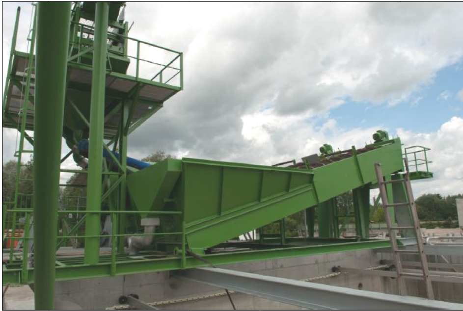
Abbildung 19: HAELA Abfallverwertung GmbH – Schwingsiebe (oben links) und Waschschnellen (© Umweltbundesamt).
