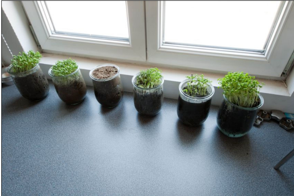
Abbildung 9: Ökotechna – Kresstests an behandelten Böden. Beim dritten von links ist der Aufwuchs fehlgeschlagen – dieses Material wird höchstwahrscheinlich deponiert werden (© Umweltbundesamt).
