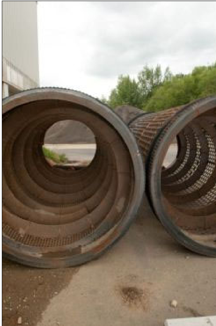
Abbildung 11: HAELA Abfallverwertung GmbH – verschiedene Einsätze für das Trommelsieb (© Umweltbundesamt).
