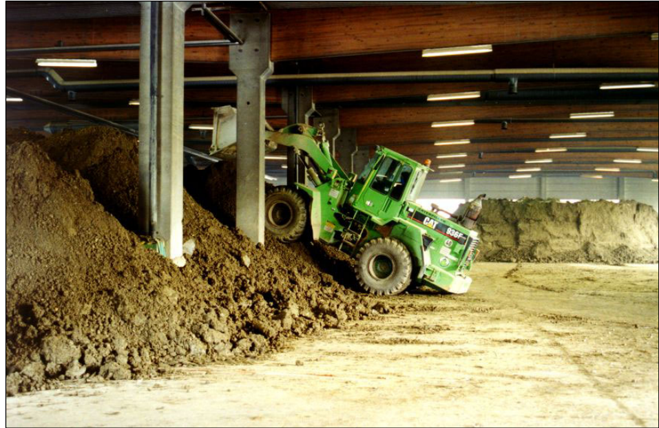
Abbildung 7: Ökotechna – Aufsetzen der Mieten (© ALTEC).
