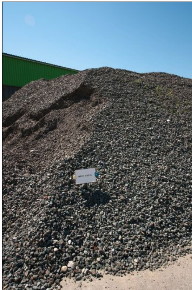
Abbildung 10: Recyclingmaterial nach der BRV-Richtlinie: RG II 0/32 A (z. B. Frostschutz- material für den Straßenbau) (© Umweltbundesamt).
