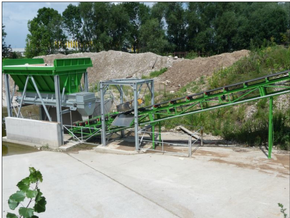
Abbildung 18: HAELA Abfallverwertung GmbH – Aufgabebereich mit Gitterrost (links) und Magnetabscheider (Mitte) (© Umweltbundesamt).
