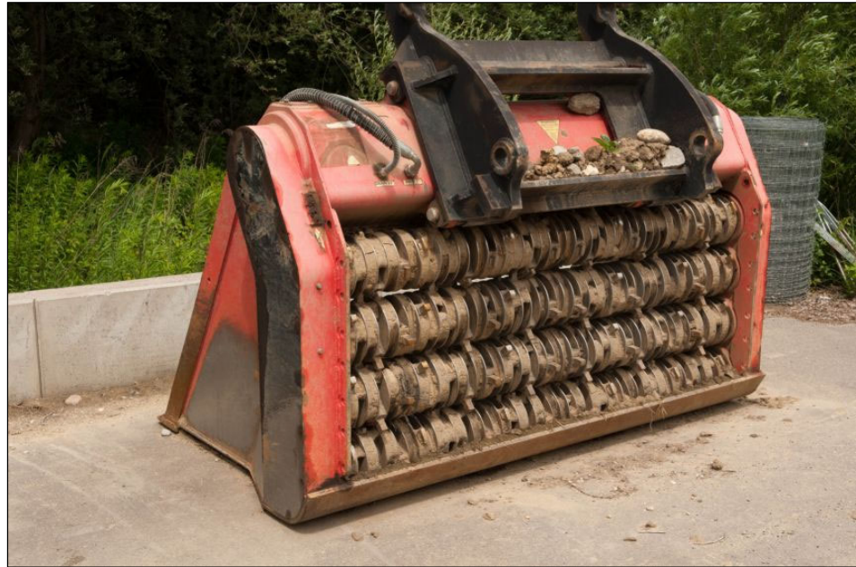
Abbildung 12: HAELA Abfallverwertung GmbH – Sieblöffel – Anbaugerät für Bagger, Radlader (© Umweltbundesamt).
