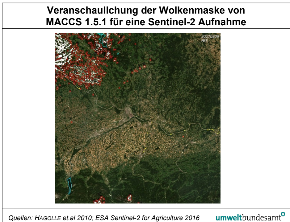
Abbildung 9: Veranschaulichung der Wolkenmaske von MACCS 1.5.1 für eine Sentinel-2 Aufnahme (T33UVP). Die rot abgegrenzten Polygone wurden vom Algorithmus erfolgreich als Wolke detektiert. Die in Echtfarben abgebildete Szene wurde am 09.08.2017 aufgenommen.
