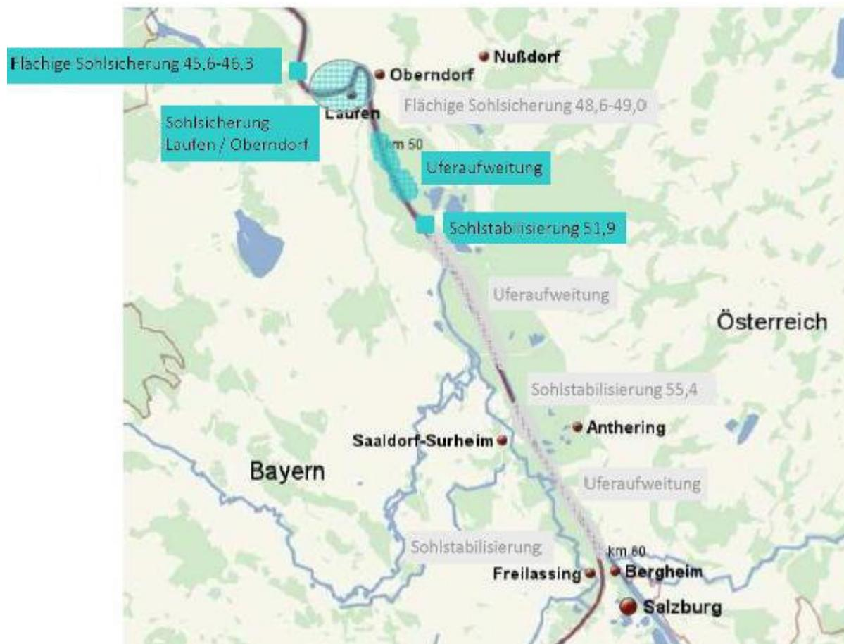
Abbildung 17: Gesamtkonzept für die Sanierung im Freilassing Becken;
