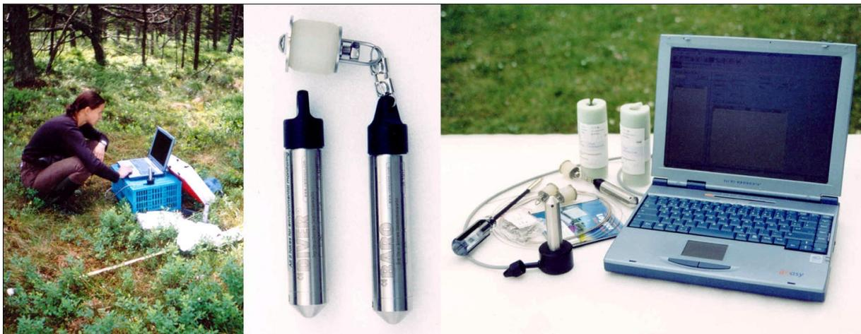
**Abb. 22:** Die im Diver bzw. Baro-Diver (Bildmitte) gespeicherten Messdaten können über eine Ausleseinheit direkt im Gelände auf ein Notebook übertragen werden.
