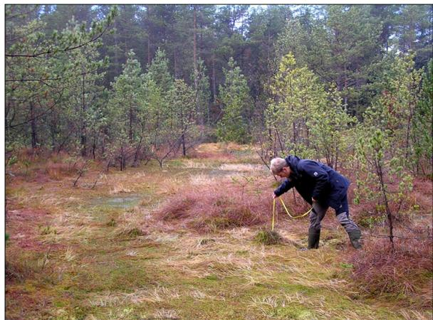
**Abb. 152:** Auslesen der Diver-Datalogger und **Abb. 153:** Kontrolle des Moorwasserstands mit Hilfe Datensicherung vor Ort im Untersuchungsgebiet des Peillots (19.11.2006)
