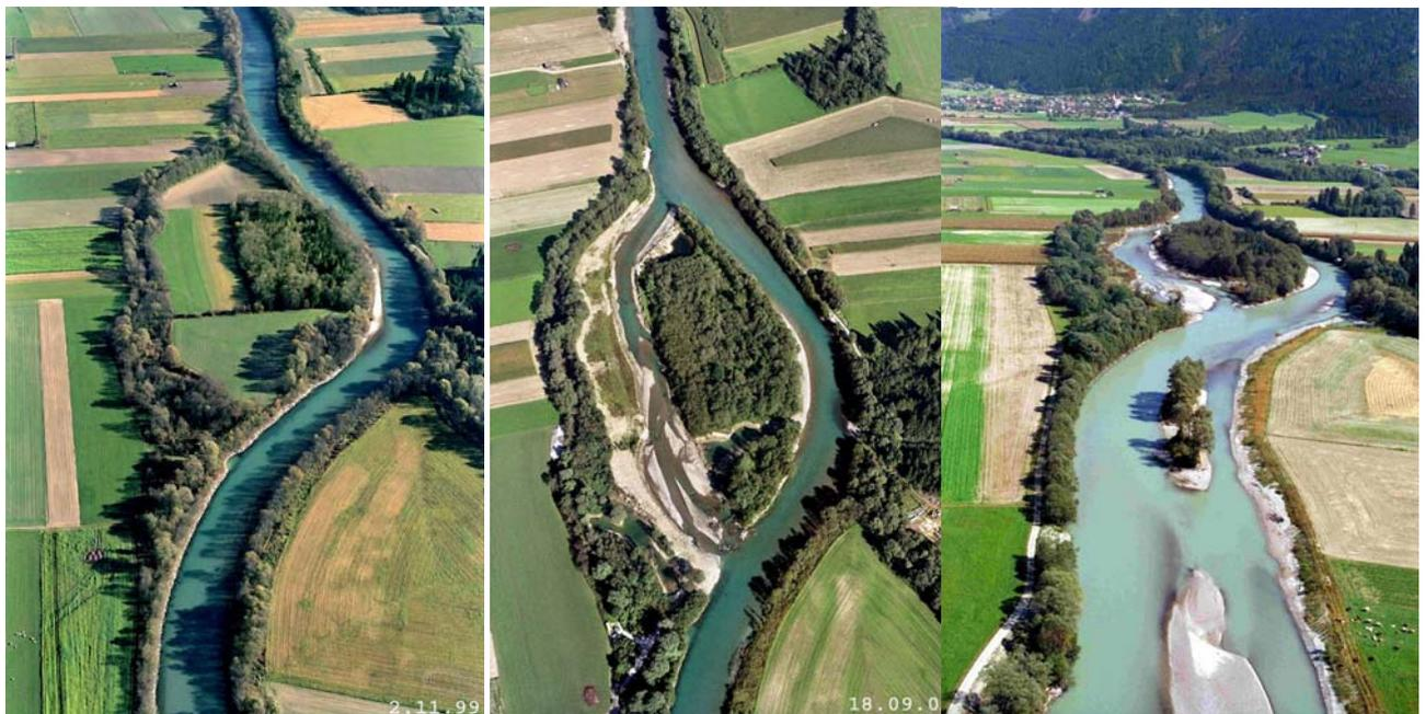
Abbildung 27: Eigendynamische Gewässeraufweitung mit Seitenerosion und Nebengewässerentwicklung an der Oberen Drau bei Kleblach (Fotos: Amt der Kärntner Landesregierung)
