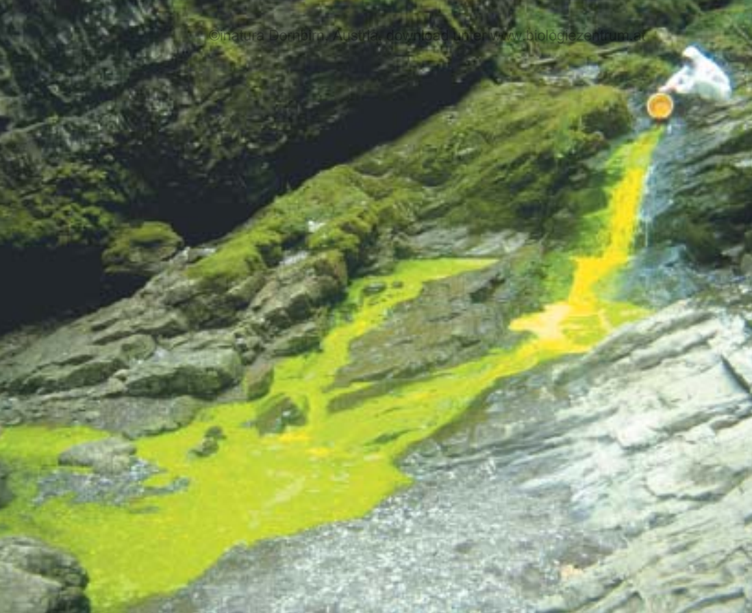
Abb. 9: Markierungsversuch im Hochifen-Gottesacker Gebiet. Durch die Eingabe des Fluoreszenztracers Uranin in den Eingang der Schwarzwasserhöhle, der zum Versuchszeitpunkt als Schwinde fungierte, konnten u.a. die unterirdischen Verbindungen zur Aubach- und Sägebachquelle belegt werden. Bei Hochwasser wird der Höhleneingang zur Quelle. Es handelt sich also um eine Estavelle.
