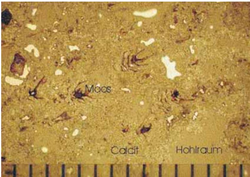
Abb. 17: Dünnschliff eines Moostuffes (Bildbreite: 16 mm)
