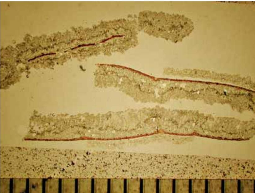
Abb. 13: Dünnschliffphoto eines umkrusteten Blattes, brauner Bereich: Blatt (organisches Material), heller, graubrauner Bereich: Kalzit, Bildbreite: 15 mm
