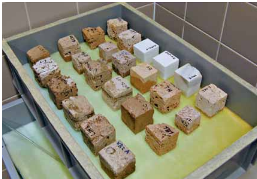
Abb. 25: Versuchsaufbau für Kapillare Wasseraufnahme: 5x5x5 cm große Gesteinswürfel werden auf eine wassergesättigte Unterlage gestellt, alle paar Minuten herausgenommen und gewogen. Aus den Daten wird ein Diagramm erstellt, aufgrunddessen unter anderem der A-Koeffizient berechnet werden kann.
