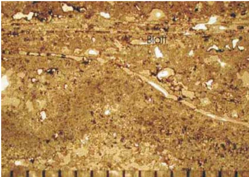
Abb. 16: Dünnschliff eines phytoklastischen Tuffes (Bildbreite: 16 mm)
