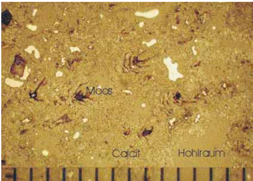
Abb. 17: Dünnschliff eines Moostuffes (Bildbreite: 16 mm)
