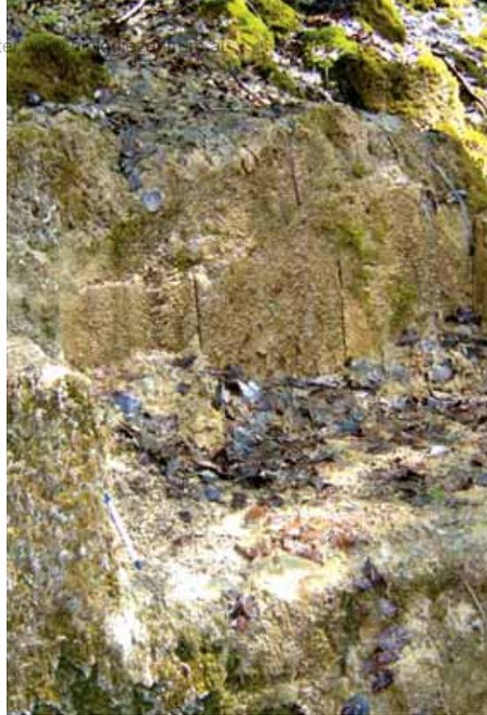
Einer der Nachteile war früher, dass es ohne elektrische Maschinen sehr aufwendig war Quelltuff abzubauen. Der Hauptnachteil von Kalktuff ist, dass er wie ein Schwamm sehr rasch und große Mengen an Feuchtigkeit aufnehmen kann. Dadurch können große Mengen an Feuchtigkeit ins Mauerwerk eingetragen werden, was zu entsprechenden Bauschäden führen kann.
