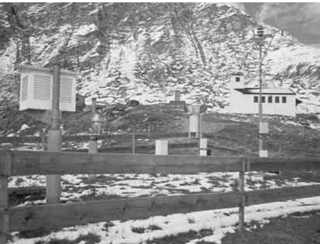
Abbildung 2: Klimastation Obervermunt mit Klimahütte im Vordergrund Niederschlagsmesser im Bildzentrum
