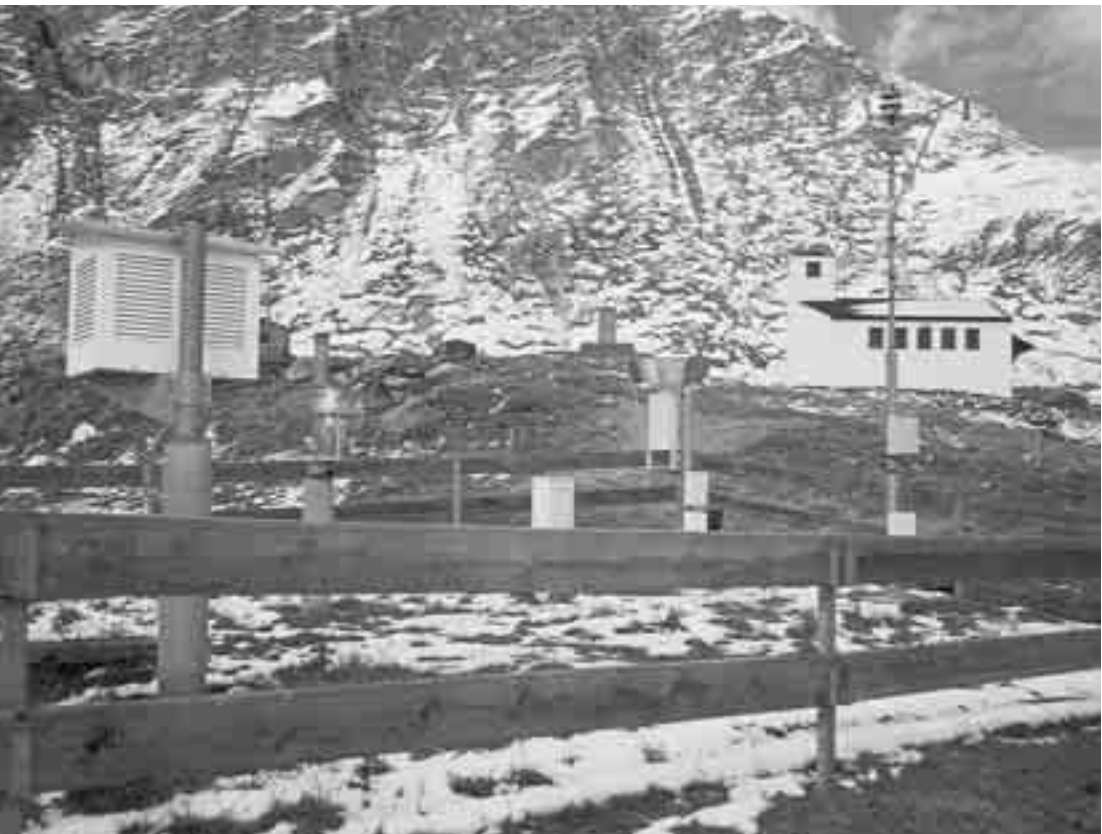
Abbildung 2: Klimastation Obervermunt mit Klimahütte im Vordergrund Niederschlagsmesser im Bildzentrum
