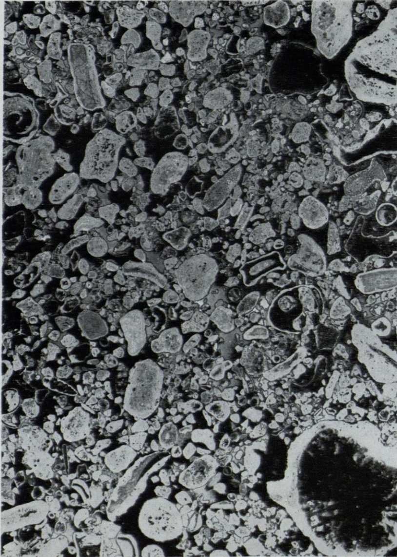
Abb. 122. Dünnschliff durch Kalkstein vom Steinbruch Dörfler 1. Zerreibsel von Organismenresten (Schalen von Foraminiferen, Algen, Spongien, Korallen, Schnecken und Muschelresten) (ca. 3fach vergrößert)
