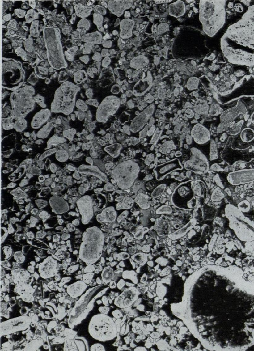
Abb. 122. Dünnschliff durch Kalkstein vom Steinbruch Dörfler 1. Zerreibsel von Organismenresten (Schalen von Foraminiferen, Algen, Spongien, Korallen, Schnecken und Muschelresten) (ca. 3fach vergrößert)
