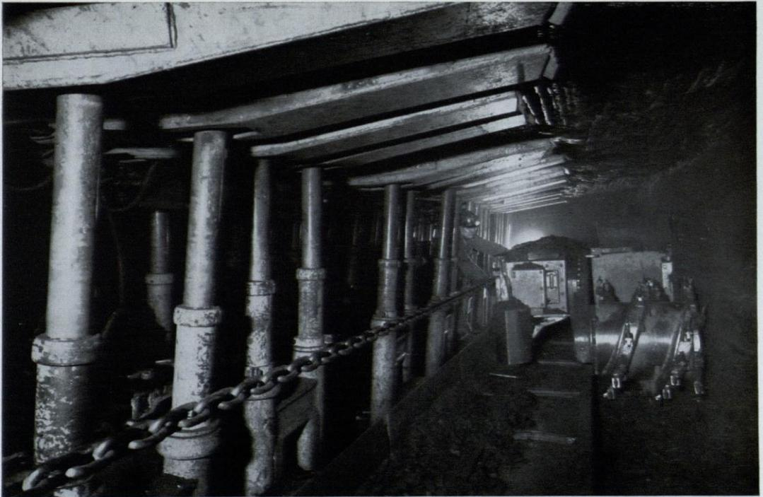
Abb. 27. Kohlegewinnung unter Tage. Mechanisierter Kohlenstreb: Walzenschrämlader und schreitender Stahlausbau (Werkphoto Wolfsegg-Traunthaler Kohlenwerke AG)
