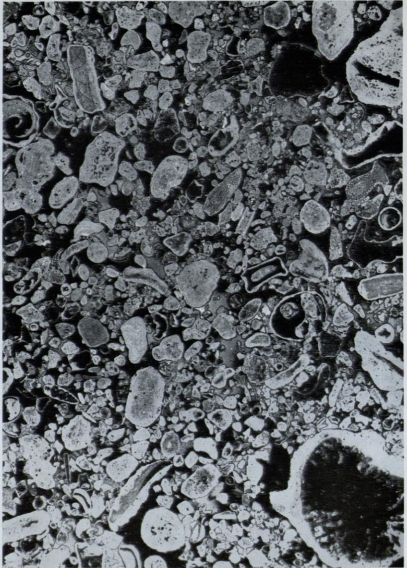
Abb. 139. Dünnschliff von einem Kalkstein des Steinbruches Dörfls 1. Zerreibsel von Organismenresten (Schalen von Foraminiferen, Algen, Spongien, Korallen, Schnecken und Muschelresten) etwa 3fach vergrößert
