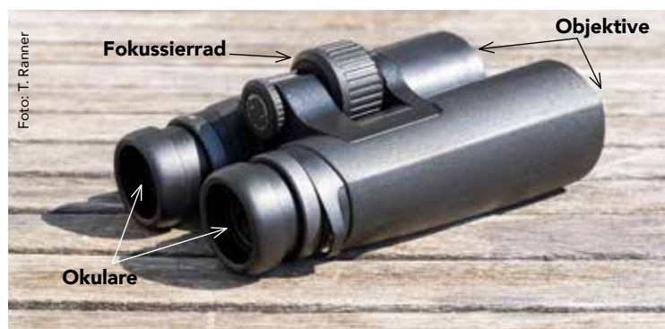
Objektiv- und Austrittspupillendurchmesser (Größe des aus dem Okular austretenden Lichtbündels) bestimmen die Helligkeit des Bildes.
