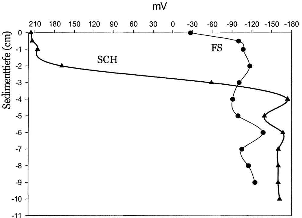
Abb. 2: Typische REDOX-Potentiale für Feinsediment (FS) und Schotter (SCH) in der Kleinen Binn (Probenstellen 6 und 13). – Typical REDOX-potential in fine (FS) and coarse (SCH) sediments of Kleine Binn.
