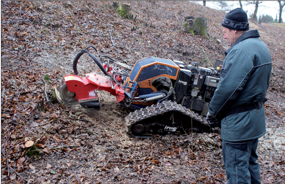
Abb. 3: Mit Hilfe von Spezialgeräten, wie dieser für sehr steile Flächen geeigneten ferngesteuerten Stockfräse, werden seit wenigen Jahren in zunehmendem Ausmaß verbuschte und verwaldete Magerrasen wieder von Gehölzen befreit und für die neuerliche Mahd hergerichtet (Foto: M. STRAUCH). – Fig. 3: Special equipment like this remote-controlled milling machine will successively remove woody plants from overgrown grasslands and prepare them for future mowing (Photo: M. STRAUCH).
