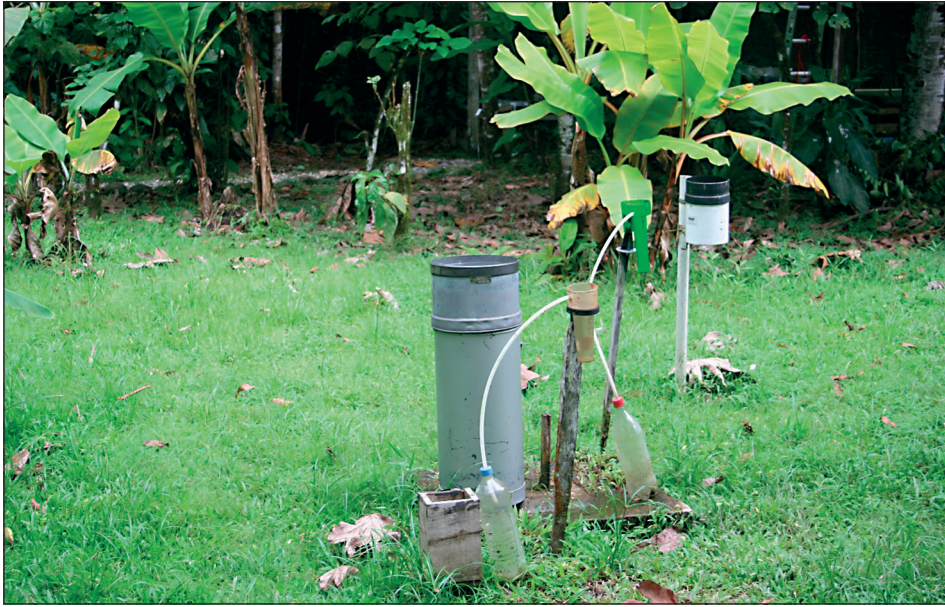
Fig. 3: Rain gauges at the Tropical Station La Gamba (Photo: B. EIBL). – Abb. 3: Regenmesser auf der Tropenstation La Gamba (Foto: B. EIBL).
