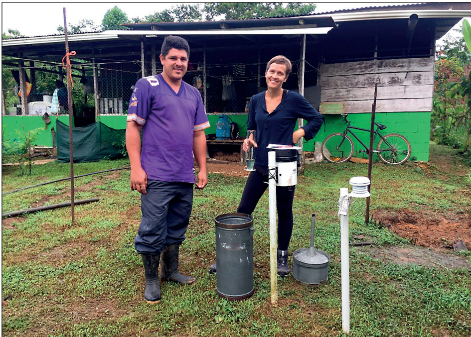
Fig. 4: Rain gauges at Finca Alexis (Photo: A. WEISSENHOFER). – Abb. 4: Regenmesser auf der Finca Alexis (Foto: A. WEISSENHOFER).
