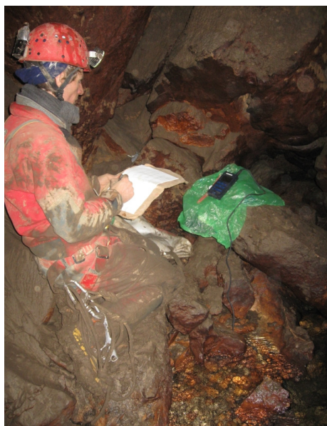
Wassertemperatur- und Leitfähigkeitsmessung in über 1000 m Tiefe am Hauptbach
