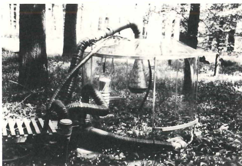
Abb. 2: Blick über das Melico-Fagetum allietosum im Untersuchungsgebiet und Ansicht einer der verwendeten Open-top Kammern (Durchmesser: 1.60 m, Höhe ohne Aufsatz: 1.25 m).
