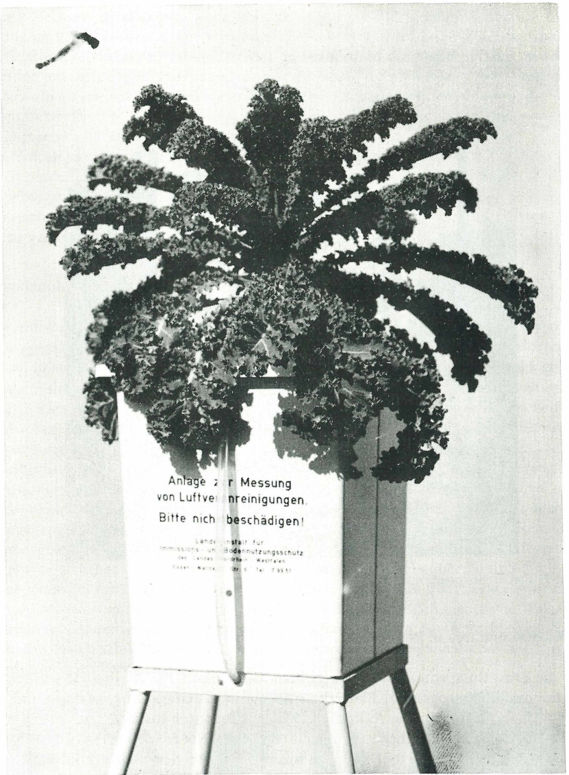
Abb. 8: Blätterkohlverfahren: Expositionsgefäß mit Indikatorpflanze.
