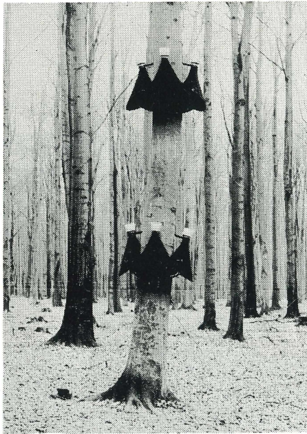
Abb. 4. Baum- Photoelektrotrapp im Buchenwald (unten offene untereinander verbundene Tuchtrichter mit Fangdose an der Spitze) – Bestimmung von Stamm- und Kronenbewohnern, Ermittlung der Entwicklungsabläufe bei Stamm- und Kronenbewohnern, Erfassung von Immigranten etc. (Näheres s. Funke 1971).
