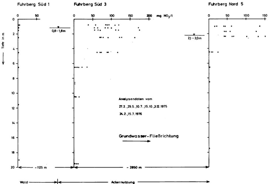
Abb. 2. Nitratkonzentration im wasserungesättigten Boden und im Grundwasser als Funktion der Tiefe bei einem Wald- und zwei Acker-Standorten.
