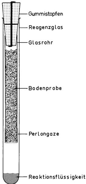
Abb. 2: Versuchsanordnung zum Nachweis der Aktivität der Mikroorganismen.
