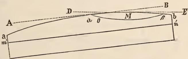
(die Mitte der Libelle) zur horizontalen Tangente DE am Puncte M, oder — was einerlei ist — die Neigung der Libellenaxe m' n' gegen den Horizont dem Winkel gleich, welchen die aus dem Krümmungsmittelpuncte zu O und M gezogenen Halbmesser mit einander machen. Diese Neigung, in Scalatheilen ausgedrückt, ist demnach dem Bogen MO gleich. Da die Mitte der Blase in dem Puncte M und die beiden Enden in  $\alpha$  und  $\beta$  liegen, so dass
