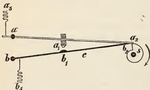
An der Steigradwelle der Normaluhr, welche zugleich den Sekundenzeiger trägt, ist eine Schnecke *s* befestigt, welche senkrecht auf die Zeichenfläche gemessen, so breit ist, dass die beiden Abfall-Lappen *a*<sub>2</sub> und *b*<sub>2</sub>, ohne sich zu berühren, auf dem äusseren
