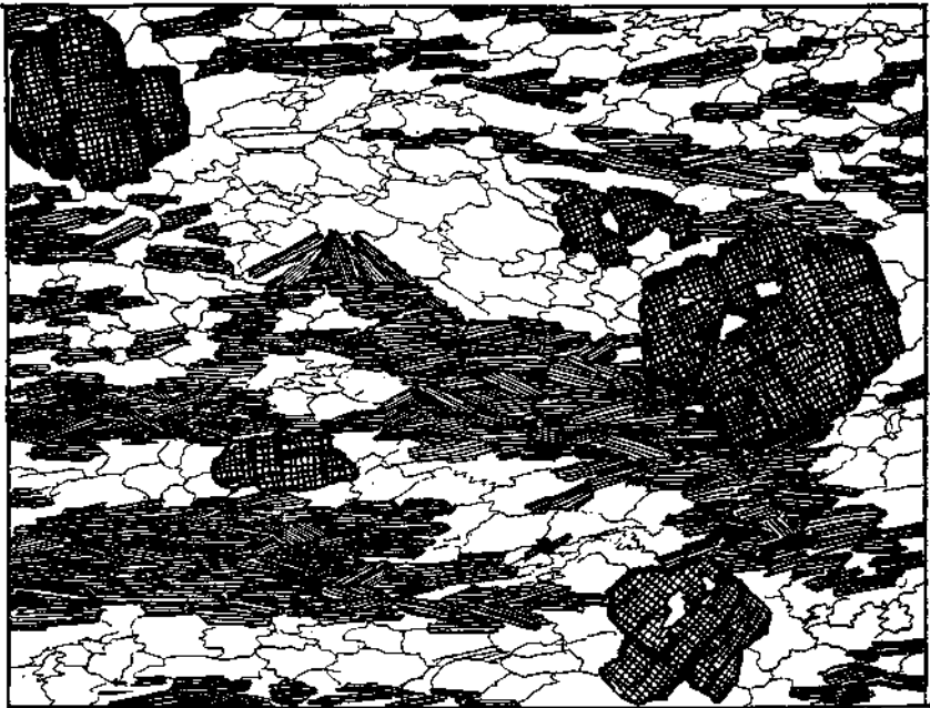
Fig. 3. Dünnschliffbild des Eisenglimmerschiefers. Weiß: Quarz und ein paar Muskovitschuppen; parallel schraffiert: Eisenglanz; gegittert: Magnetit.
