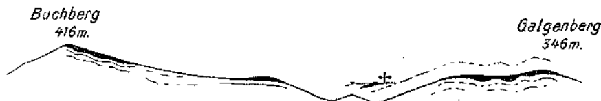
Geologischer Schnitt vom Buchberg zum Galgenberg bei Mailberg, N. Ö. Schwarz: Algenkalk; weiß: Gründer Schichten (?). Lössdecke weggelassen.
