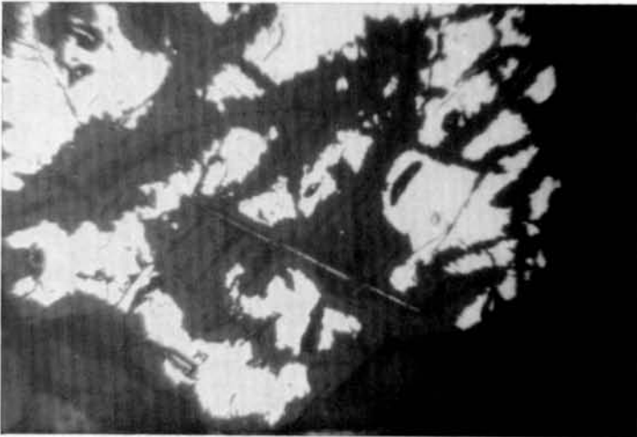
Abb. 3. Magnetit mit Verdrängung von Maghemit, 600mal, Ölimmersion.
