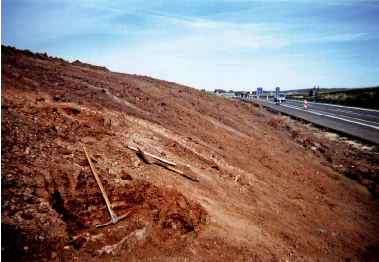
Abb. 3 Frei geschürfte Hornsteinlinse in einer Serie feinklastischer Sedimente/Pyroklastite, Böschung an der Autobahn A 72, Anschlussstelle Zwickau-Ost.
