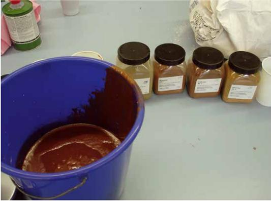
Abb. 10 Harzeinfärbung mit Pulverfarben.
