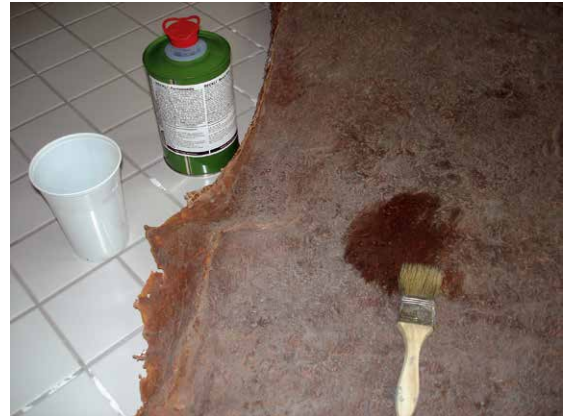
Abb. 7 Aufbringen des Formenwaxes.
