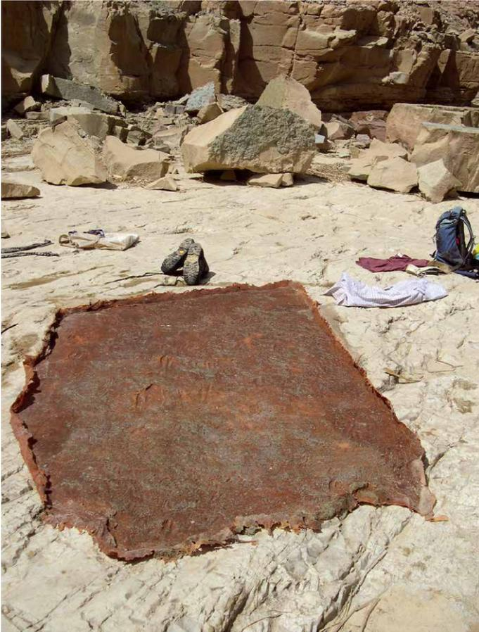
**Abb. 6** Fertiggestellte, absolut detailgetreue Latex-Abformung.
