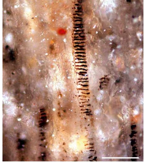
Abb. 43 Radialschnitt durch das Holz zeigt die treppenartige Wandstruktur der Tracheiden, Maßstab 100 µm.
