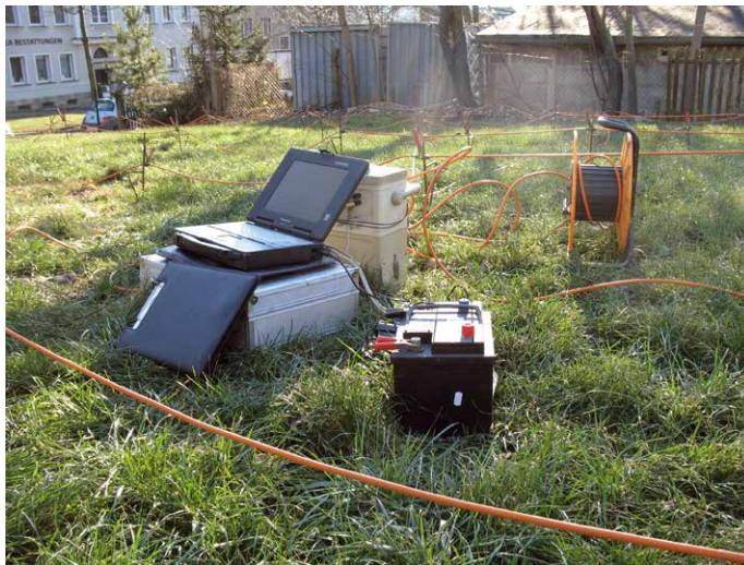
Abb. 8 Messanordnung der widerstandsgeoelektrischen Flächenmessung vom 13.01.2008 auf der Rasenfläche.
