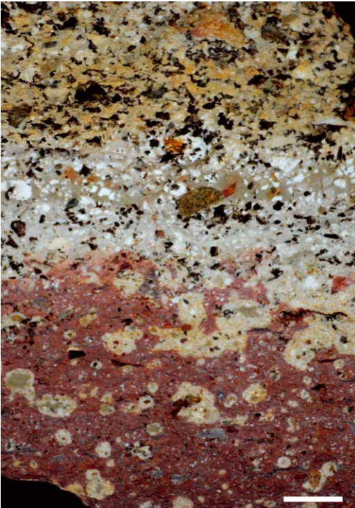
Abb. 22 Zunehmend hellgrau-grünlich gebleichter, Bimsfragmente und Lithoklasten führender Aschentuff vom Top der Schicht 5, Maßstab 10 mm.
