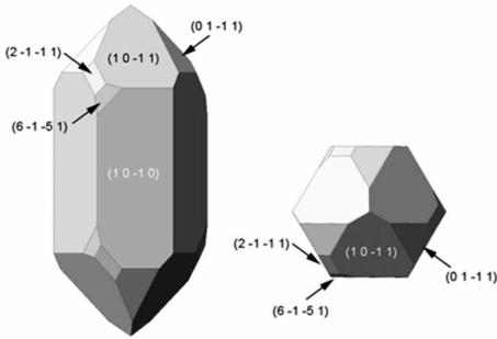
**Abb. 3** □-Quarz (Linksquarz), Blick entlang der □-Achse (links) und der c-Achse (rechts) nach BUBENIK.
