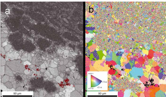
kryptokristallinen Quarz ersetzt (Abb. 12). Dagegen findet sich überall im Festigungsgewebe mikrokristalliner Quarz (rechts oben im Bild), der die verdickten Zellwände erhalten hat und durch die anatomischen Details in diesem Bereich besonders kleine Kristallite gebildet hat.
