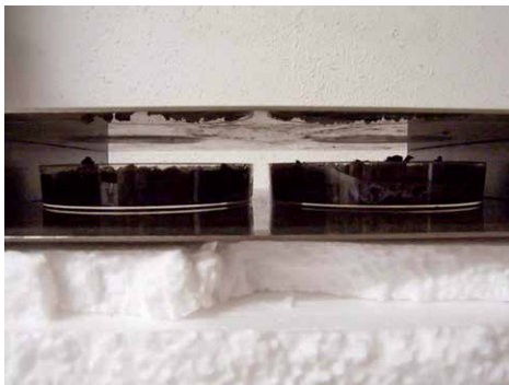
Abb. 9 Petrischalen im Plattenkondensator.
