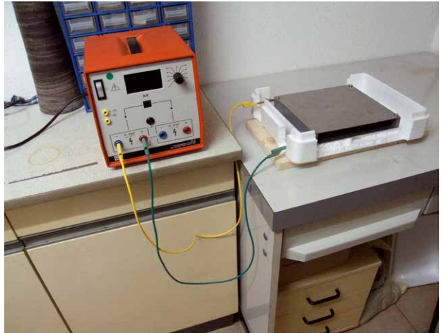
Abb. 8 Versuchsanordnung (v. l.: Netzgerät, Bananenstecker, Plattenkondensator).
