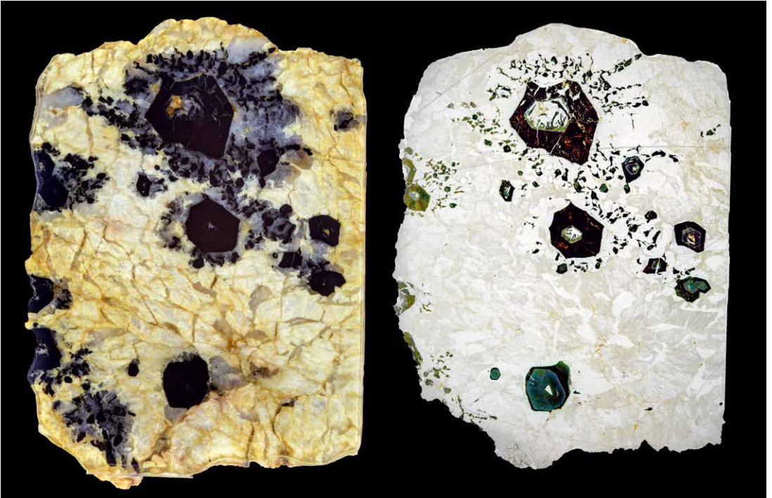
Abb. 5 Dick- und Dünnschliff mit grafischer Verwachsung von Quarz (weiß), Feldspat (ockerbraun) und Schörl (schwarz) mit gefüllten Schörlkristallen.
