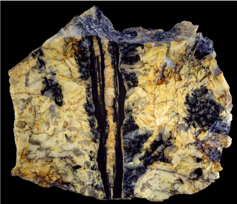
Abb. 5 Dick- und Dünnschliff mit grafischer Verwachsung von Quarz (weiß), Feldspat (ockerbraun) und Schörl (schwarz) mit gefüllten Schörlkristallen.
