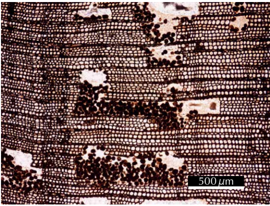
Abb. 15 Detail aus Abb. 14, rechtwinklig angelegte Fraßgänge mit glatten inneren Oberflächen.
