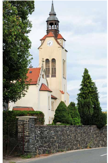
Abb. 27 | Stenn: Bruchsteinmauerwerk an der Friedhofsmauer und Schichtmauerwerk am Pfeiler.
