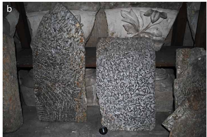
Abb. 19 Im Depot des Naumburger Doms befinden sich Reste geschädigter, ausgebauter Garbenschieferplatten vom Dorsale (a) sowie vermutlich nicht genutztes Ergänzungsmaterial (b).
