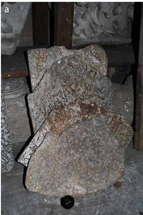
Abb. 19 Im Depot des Naumburger Doms befinden sich Reste geschädigter, ausgebauter Garbenschieferplatten vom Dorsale (a) sowie vermutlich nicht genutztes Ergänzungsmaterial (b).
