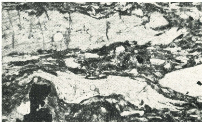
Abb. 6 vitrophyrischer Quarzporphyr-Ignimbrit, Karl-Marx-Stadt—Altendorf, Vergr. 100mal, 1 Nicol. Größere Glasfetzen (im Bild oben und Mitte) von kleineren Fetzen umgeben. Daneben Bruchstücke von eingesprengtem Quarz und Plagioklas.
